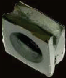
Inserto original desgastado
