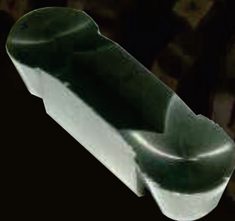
Inserto original desgastado
